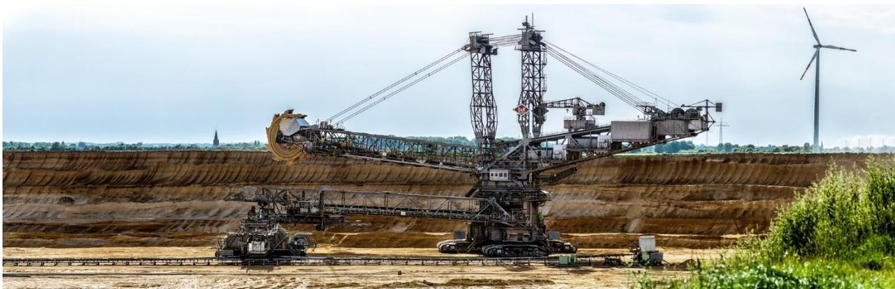
*Abbildung 2: Gelebte Energietransformation - im Vordergrund ein Schaufelradbagger und der Abbau fossiler Energieträger, im Hintergrund eine Windkraftanlage zur Nutzbarmachung Erneuerbarer Energien. (Quelle: pixabay)*
