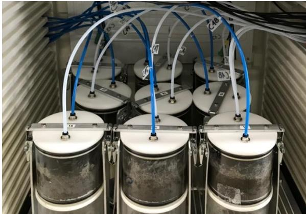
Abbildung 4: Inkubationsversuch am KIT-Campus Alpin. Messung der Emission von Lachgas, Ammoniak, Methan und Kohlenstoffdioxid aus Böden, welche zuvor mit co-fermentierten Gärresten aus Rindergülle und Braunkohle bzw. Pflanzenkohle gedüngt wurden.
