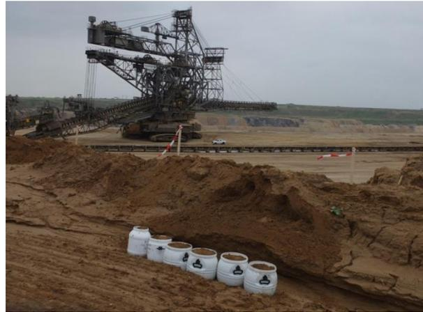
Abbildung 2: Probenahme von unverwittertem Lösssubstrat (Rekultivierungsboden) aus einer Rekultivierungsfläche am Tagebau Garzweiler.
